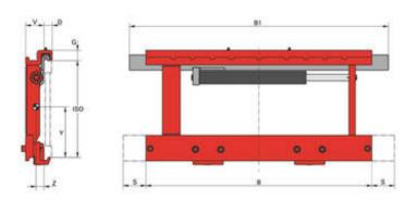
Containerseitenschieber - 1 Hydraulikfunktion
